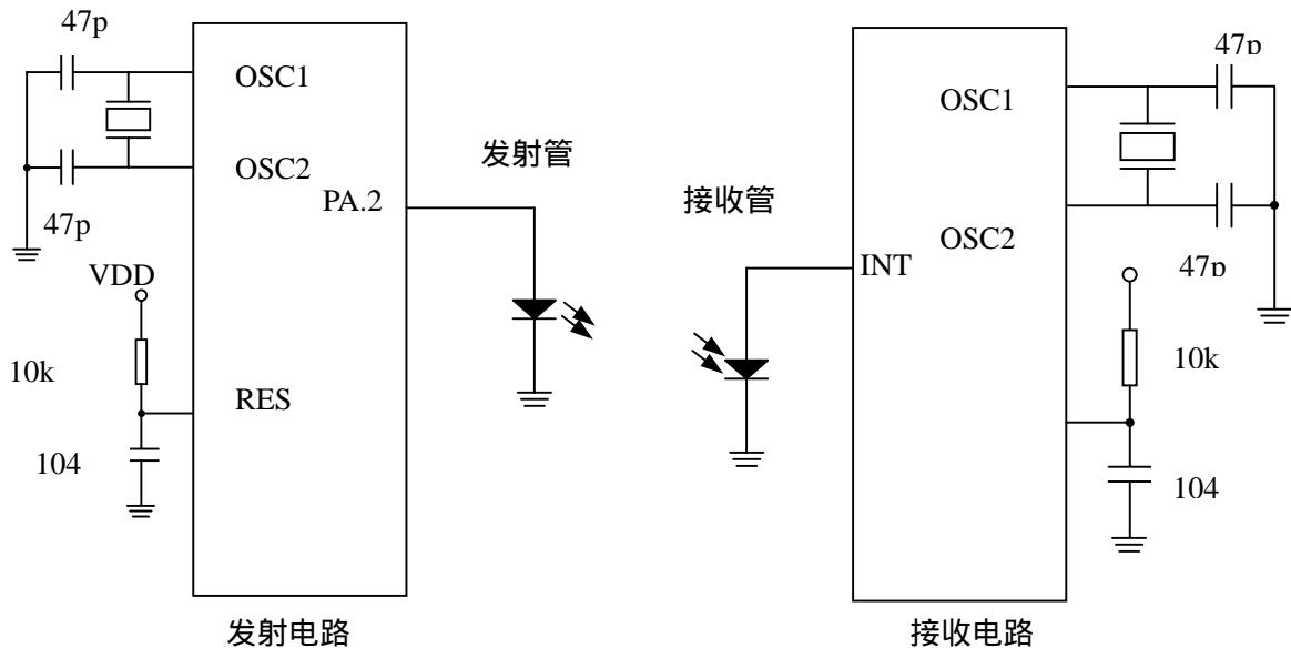
用两个 HT47R20A-1 单片机来实现 IR 的发射和接收。其编码方式为：1 位启始信号+8 位数据信号。
